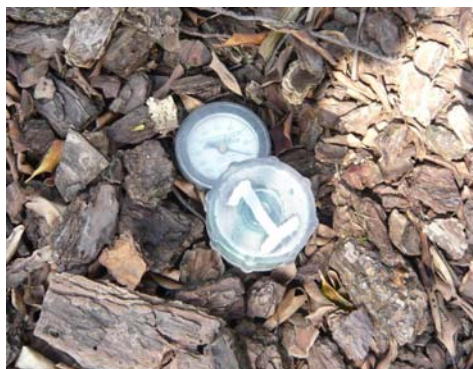
照片 6 — 在樹根區安裝張力儀，以監察土壤的水分
