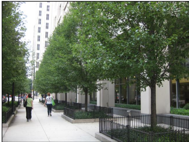
圖 6 樹木根領周圍蓋上混凝土的不當例子
