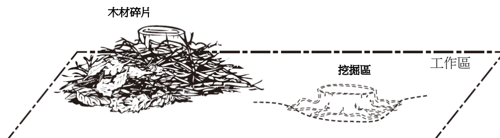
移除並處理樹樁、樹根及相關土壤
